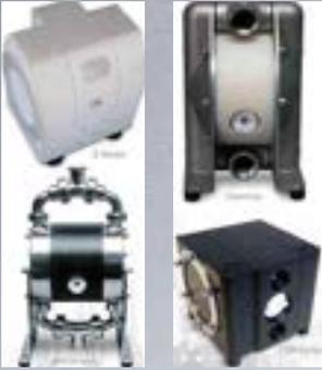
Le pompe pneumatiche autoadescanti a doppia membrana della nostra rappresentata Almatec, realizzate in diversi materiali come polietilene (PE ad alto peso molecolare o alta densità), PTFE vergine o acciaio inox AISI 316 sono adatte al travaso di acidi, liquidi corrosivi in genere, solventi, liquidi abrasivi o contenenti parti solide. Portate da 0,9 a 48 metri cubi/ora. Capacità di adescamento a secco da 1 a 5 mt e fino a 9,5 mt quando innescate.
